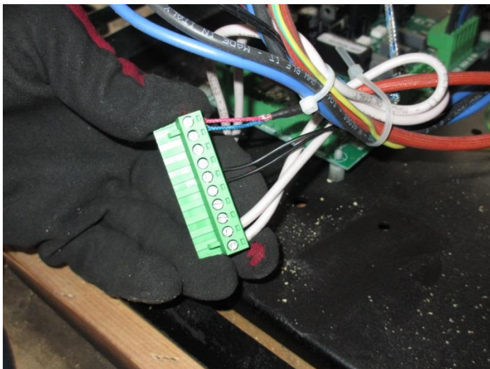
②排気温度センサーのケーブルが接続されているコネクタを基盤より外し、固定ビスをドライバーで緩めます。
